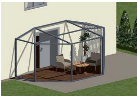
Wintergärten mit abgeschrägten Ecken sind weniger gefährlich. Solche mit vielen Rahmen und vergleichsweise kleinen Glasflächen sind vogelfreundlicher. Und es wird auch günstiger, wenn mal eine Scheibe ersetzt werden muss...
